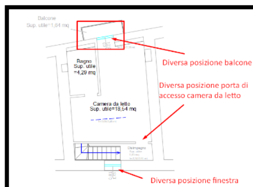
Fig. n. 34 -Rilievo piano secondo
