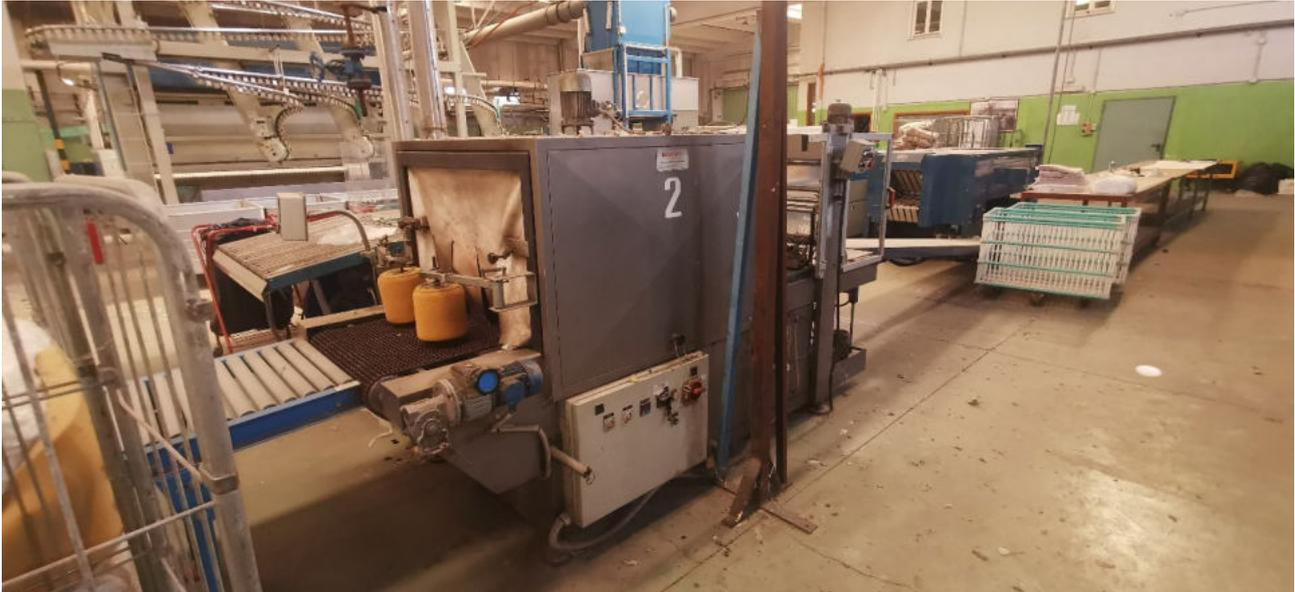
Foto 35: Piegaspugne Montanari con impacchettatrice.
