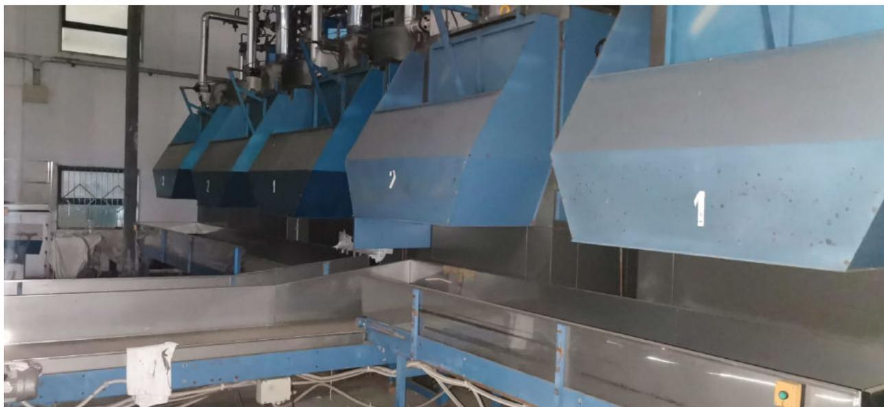
Foto 10: Sistemi pre-presa e nastri trasportatori linee 1 e 2.
