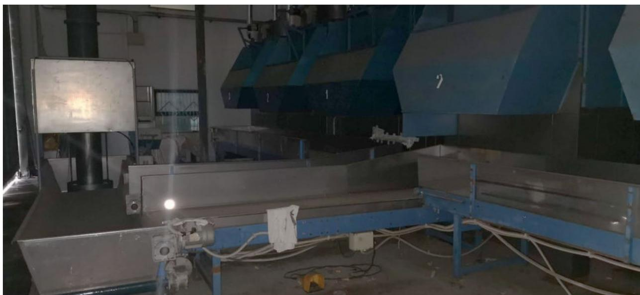
Foto 11: Sistemi pre-presa e nastri trasportatori linee 1 e 2.
