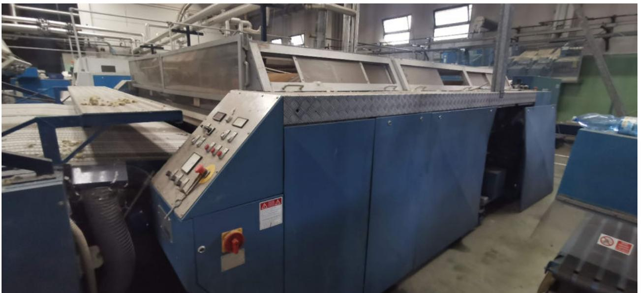
Foto 28: Mangano ad olio diatermico tre rulli Passat
