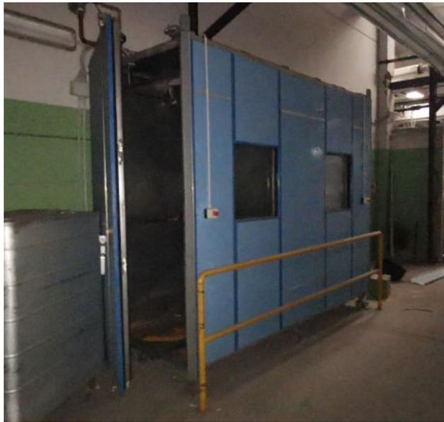
Foto 5: Cabina sterilizzatrice materassi.
