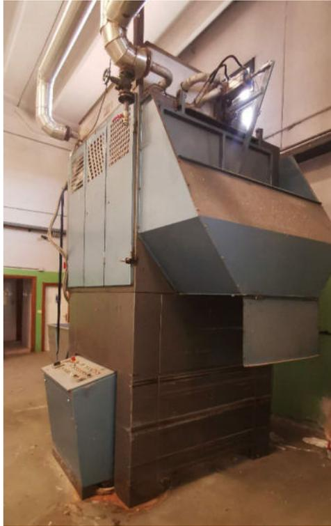
*Foto 14: Essiccatore ad olio diatermico Passat-*
