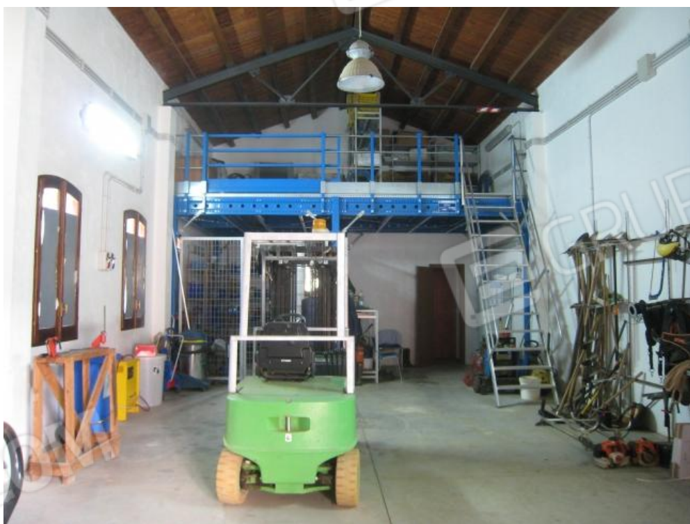
Foto n. 105. L'officina e deposito attrezzi. Il soppalco è del tipo smontabile e reversibile.
